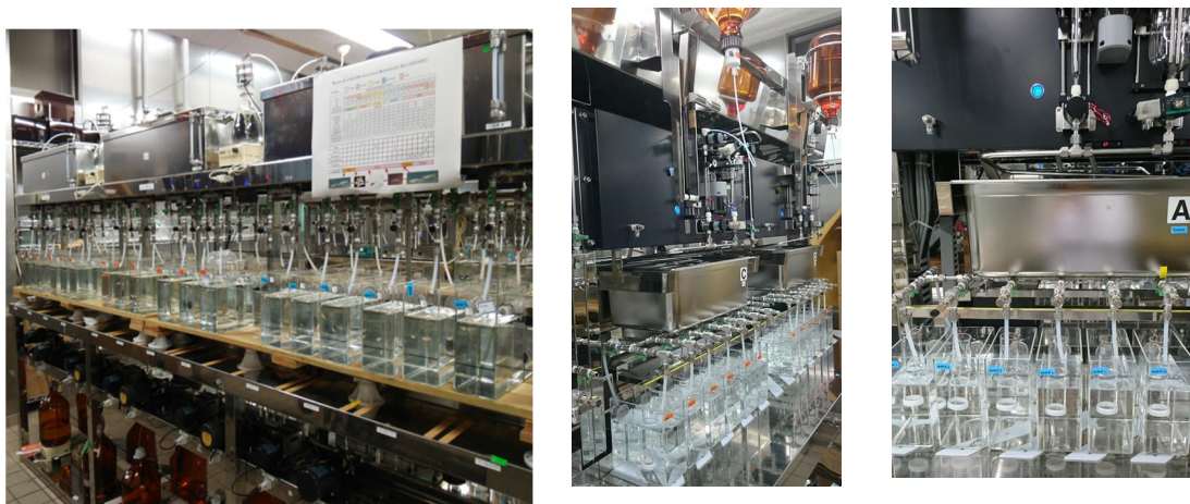
図 1 流水式装置（左：1号機、中央：2号機、右：2号機・ふ化器をセット）
