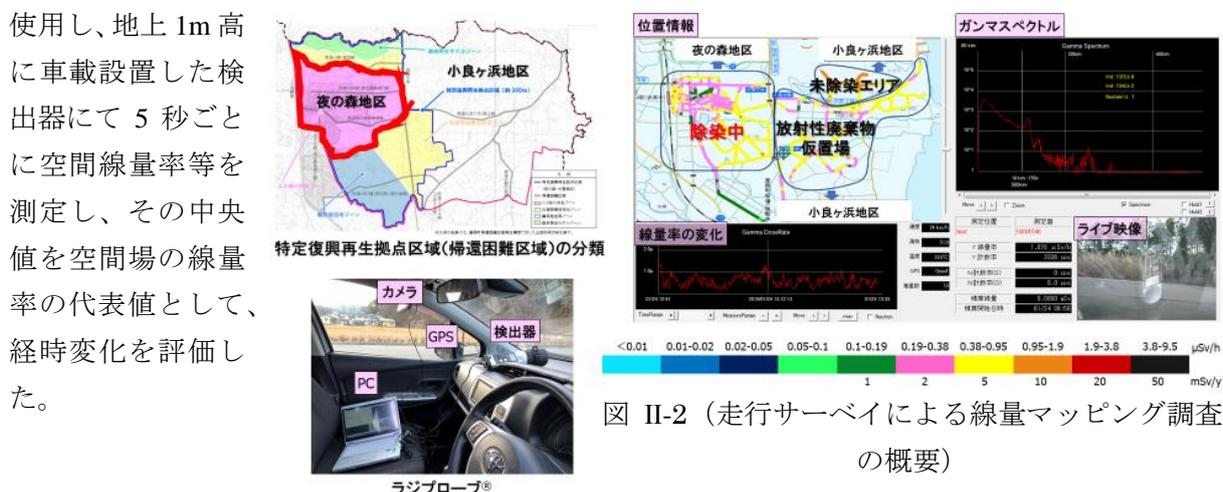
図 II-2 (走行サーベイによる線量マッピング調査の概要)
