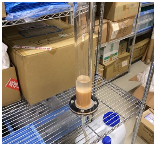
図 II-3 カラムにイオン交換樹脂を入れて試料水を流している様子。
