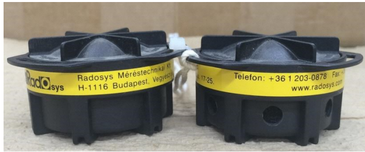
図 II-5 RADUET の外観。左が低換気率容器であり、右が高換気率容器である。高換気率容器には 6 個の穴が開いている。
