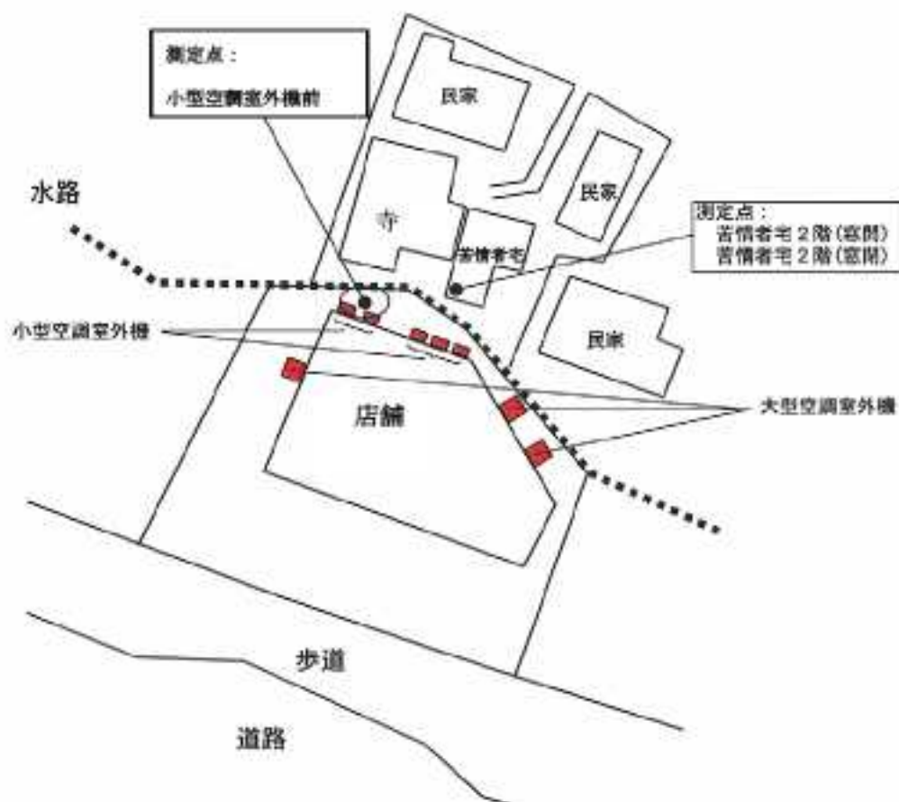
図 3-18-1 発生源側と苦情者宅の意図関係および測定点
