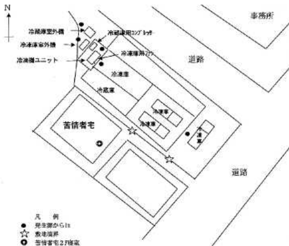
図 3-13-1 発生源側と苦情者宅の位置関係および測定点配置
