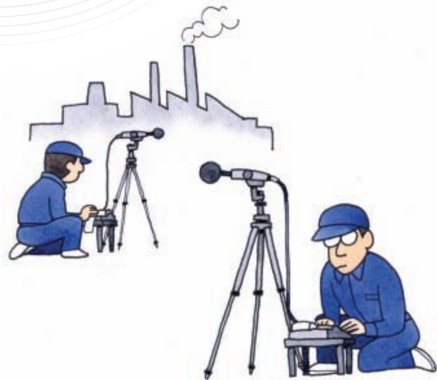
7) 低周波音の問題が発生している家屋側と発生源側とで低周波音を同時に測定し、発生源と思われる施設などが動いている時と止まっている時の、低周波音の大きさの変化や周波数の特徴を比較します。
