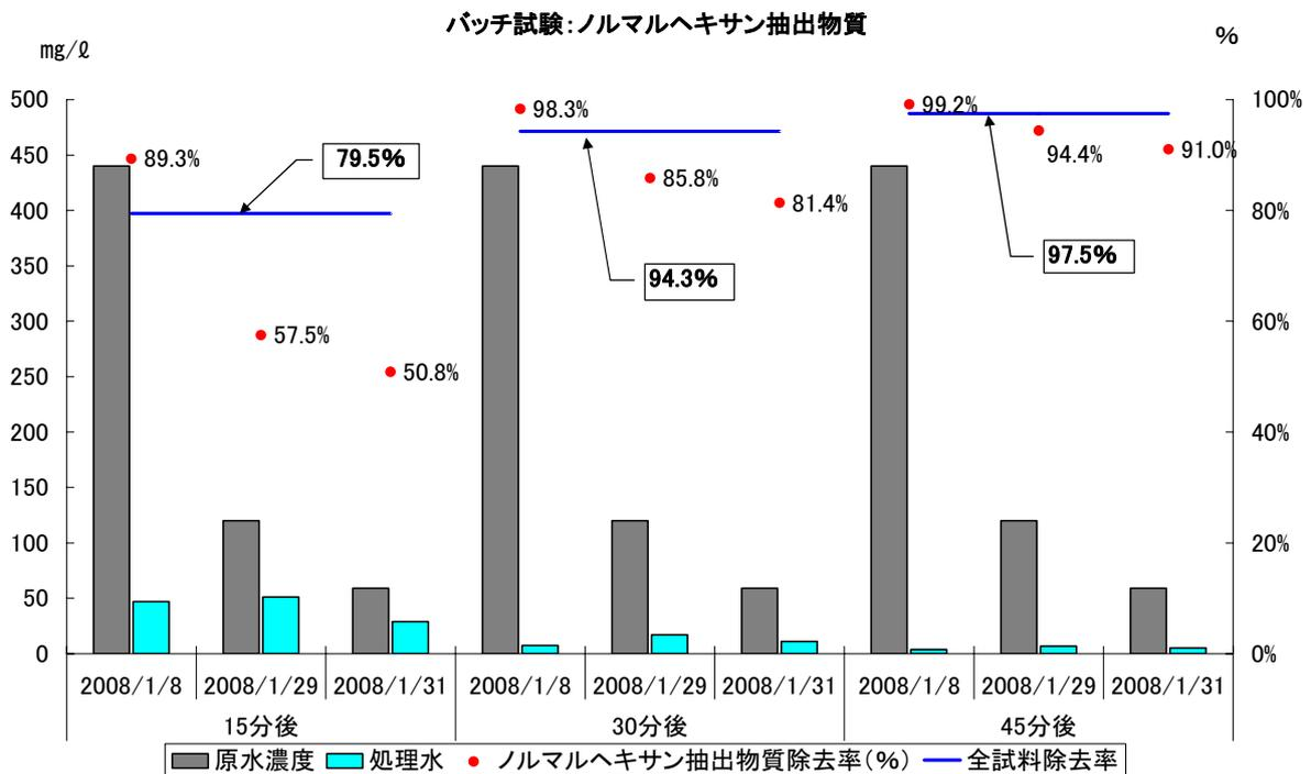
図 5-25 追跡調査バッチ試験（ノルマルヘキサン抽出物質）
