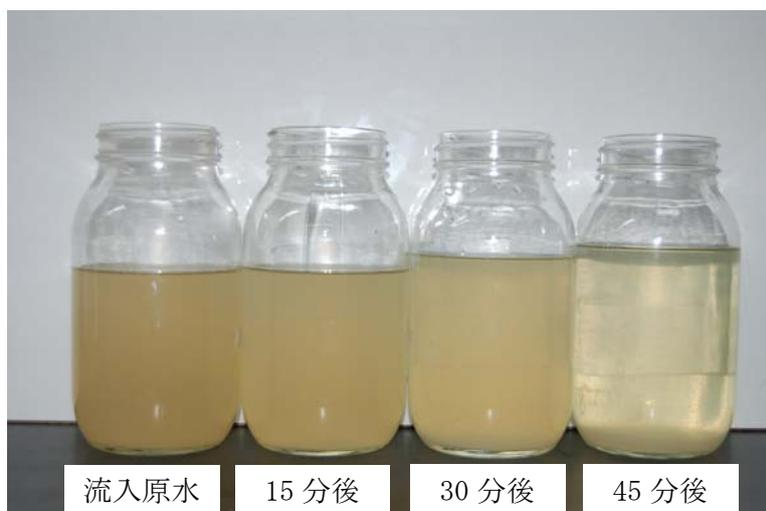
バッチ試験における処理水の状況
