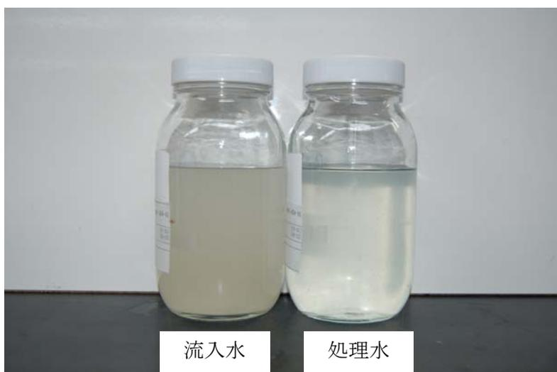
移送水量 5L/minにおける流入水および処理水
