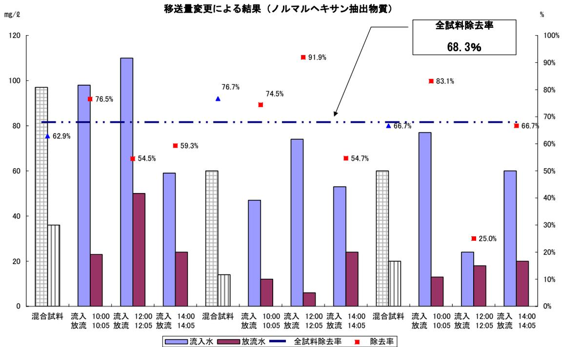
図5-19 移送量変更による結果 (ノルマルヘキサン抽出物質)
