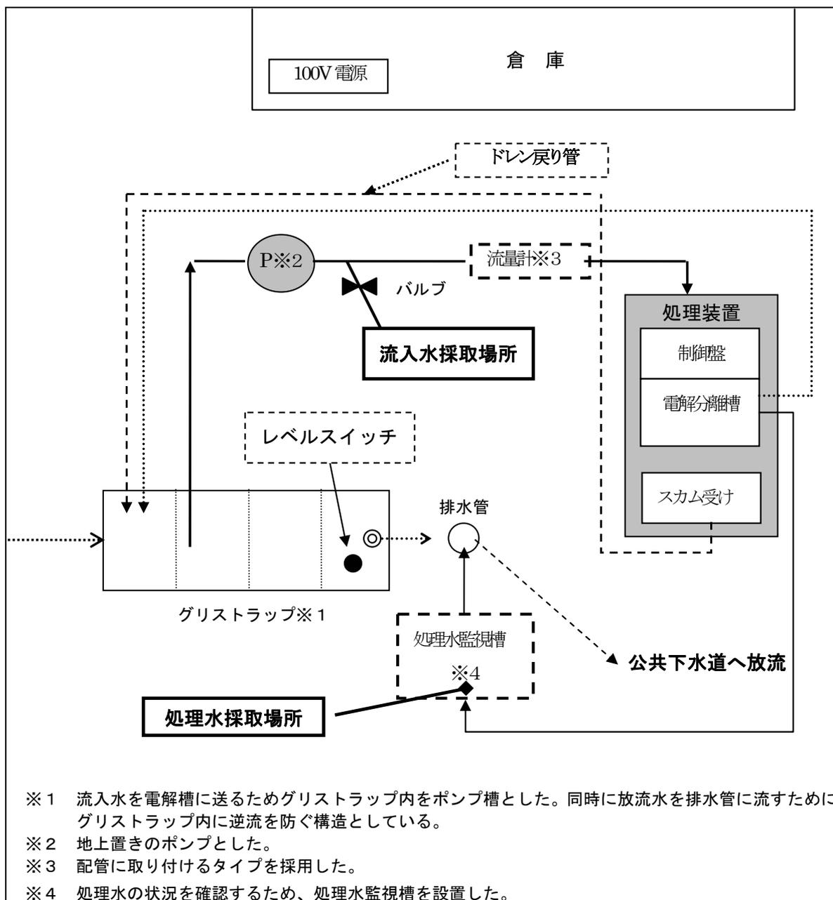
図3-1 実証対象機器の配置図（平面図）
