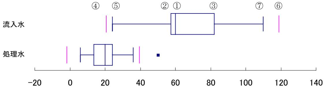
図5-17 移送量変更による箱型図（ノルマルヘキサン抽出物質）
