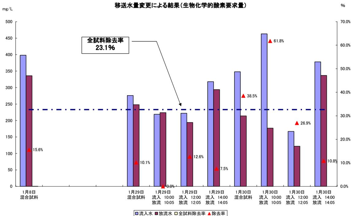
図5-20 移送量変更による結果 (生物化学的酸素要求量)
