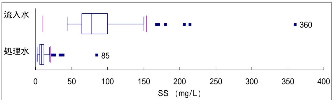
図4 - 3 - 1 流入水と処理水の箱ひげ図 (pH、BOD、COD、SS)
