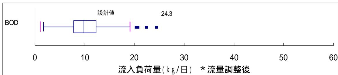
図4 - 4 - 1 流入負荷量の箱ひげ図（BOD）
