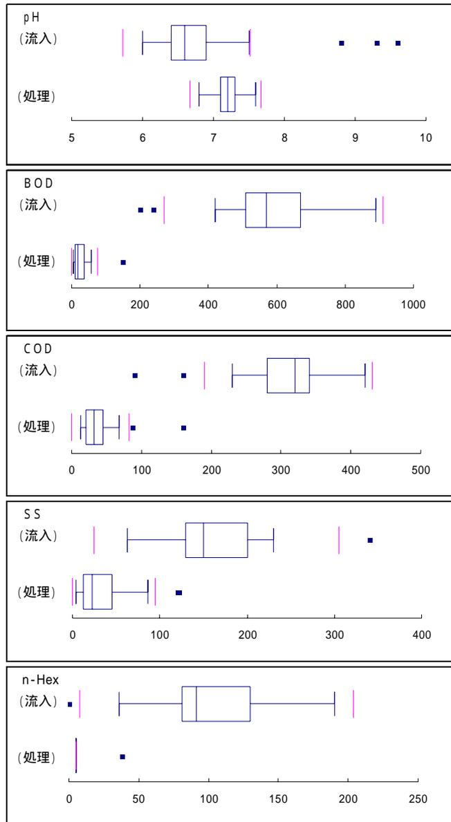
注1: 除去効率は定期試験の「(流入水の総汚濁負荷量 - 処理水の総汚濁負荷量) / 流入水の総汚濁負荷量」より算出
