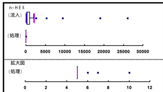
注1: 除去効率は定期試験の「(流入水の総汚濁負荷量 - 処理水の総汚濁負荷量) / 流入水の総汚濁負荷量」より算出
