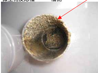
図5 - 15 配管詰まりの状況写真
