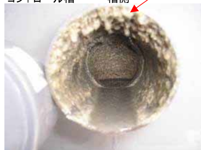
図5 - 15 配管詰まりの状況写真
