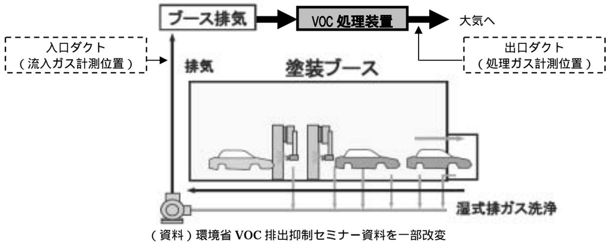
図表 3 金属製品製造業における VOC 排出イメージ
