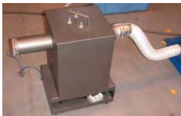
図 4 - 1 : ジクロロメタン等脱脂装置シミュレーター
