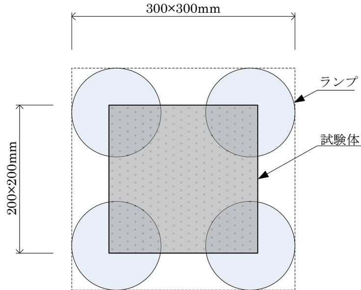
図 2 ランプと試験体の位置
