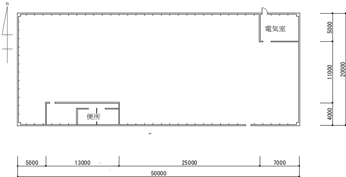
図 7 計算用工場モデル（平面図）
