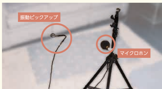
室内（測定地点⑤）の測定機材の設置例
