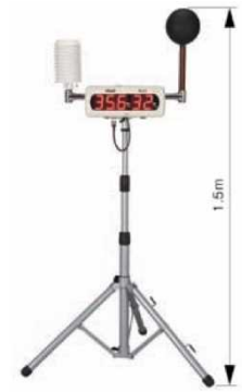
図 5.7 WBGT 測定装置 (演算型)の例
