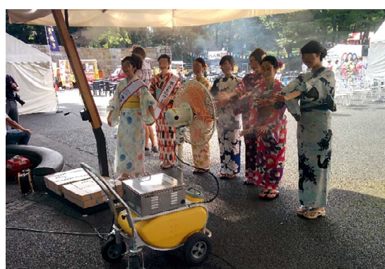
↑移動式の送風ファン付き微細ミストの例
