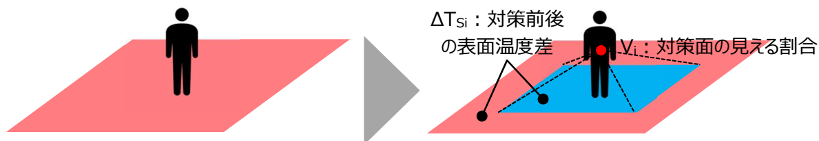
図 2 路面の高温化抑制対策のイメージ
