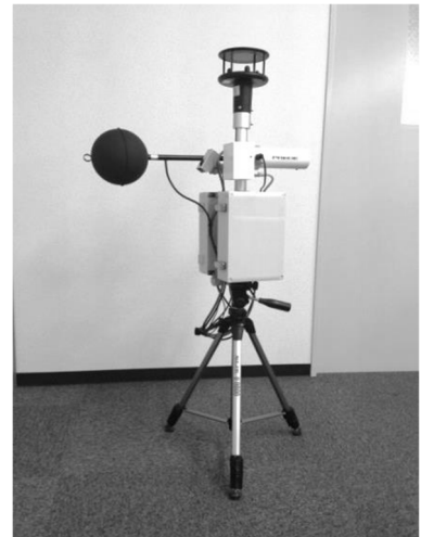
図 5.2 温熱 4 要素を測定する機器の例
