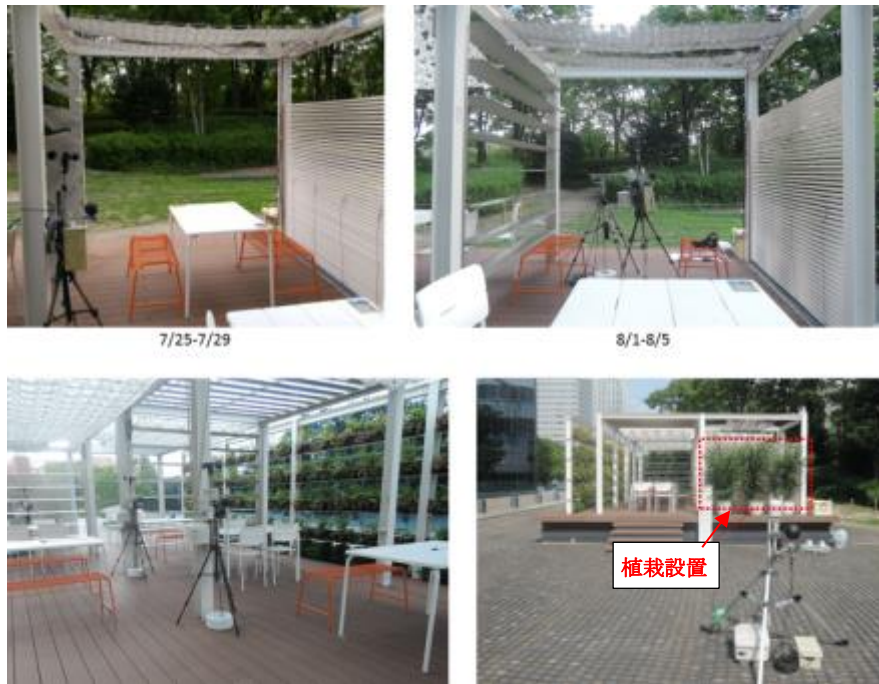
図 5.32 気温・湿度・風向風速・長短波放射計の設置方法
