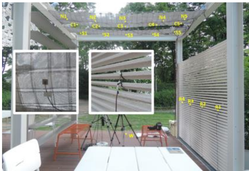
図 5.33 熱電対の設置方法
