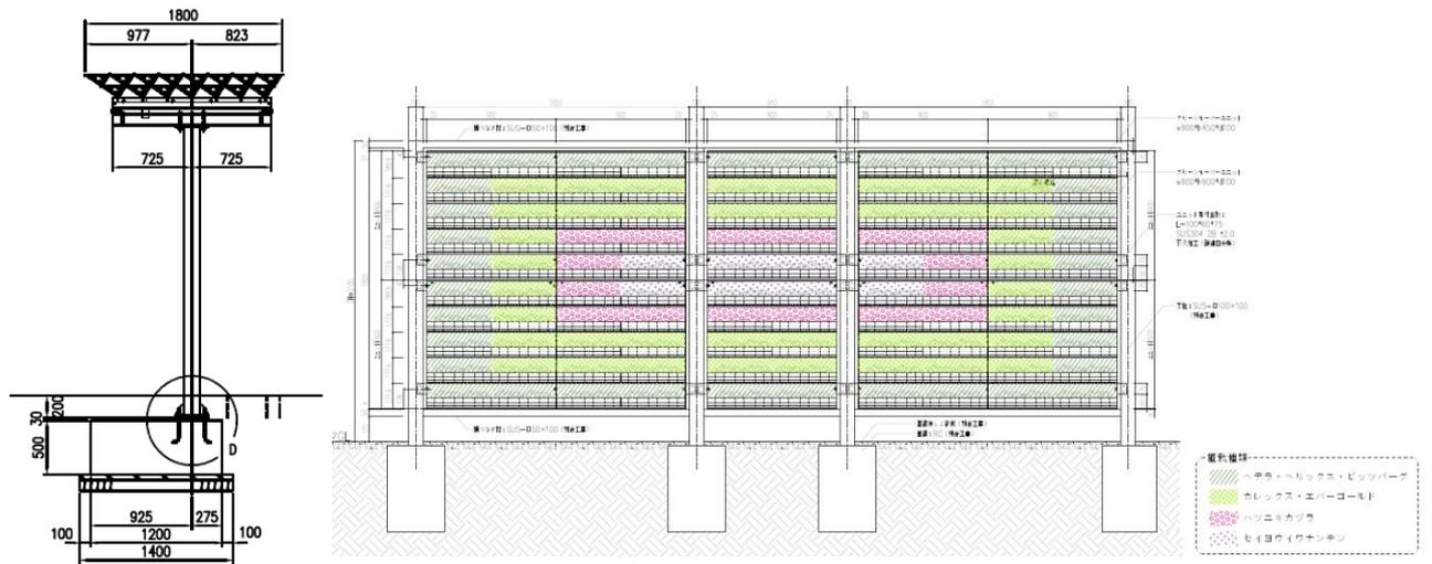
図 4.35 設計立面図 (左：フラクタル形状の日除け、右：緑化冷却ルーバー)
