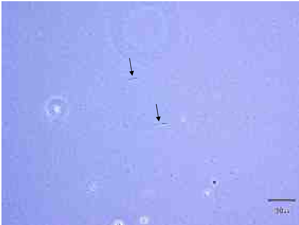
写真 15. 試料 No.21 で検出された繊維。偏光顕微鏡観察で角閃石系アスベストと判定したが、種類は確定出来なかった。(位相差像)
