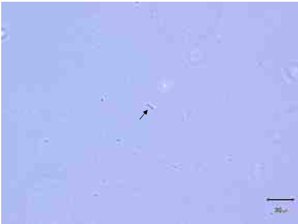
写真 1. 試料 No.5 で検出されたクリソタイル。(位相差像)
