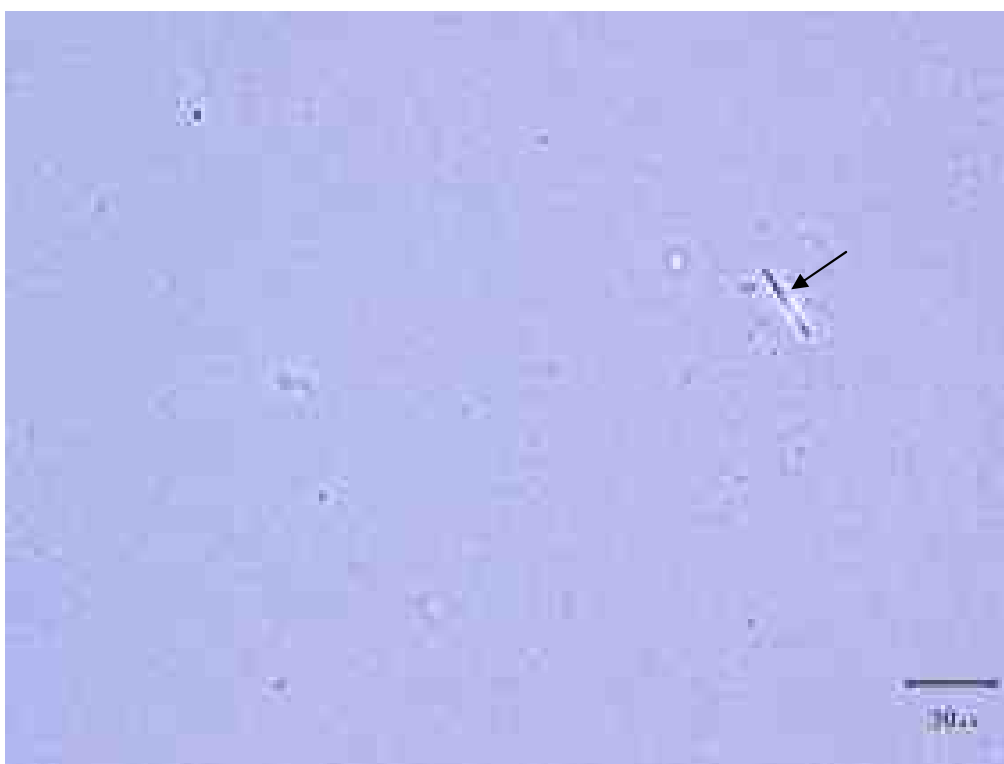
写真 8. 試料 No.10 で検出されたクロシドライト（位相差像）。
