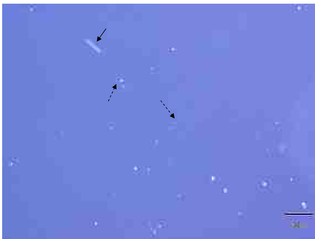
写真 7. 「写真 6.」の偏光顕微鏡観察（直交ニコル）。写真ではクリソタイルが 判別しにくい各繊維は対角位で干渉色を示している。
