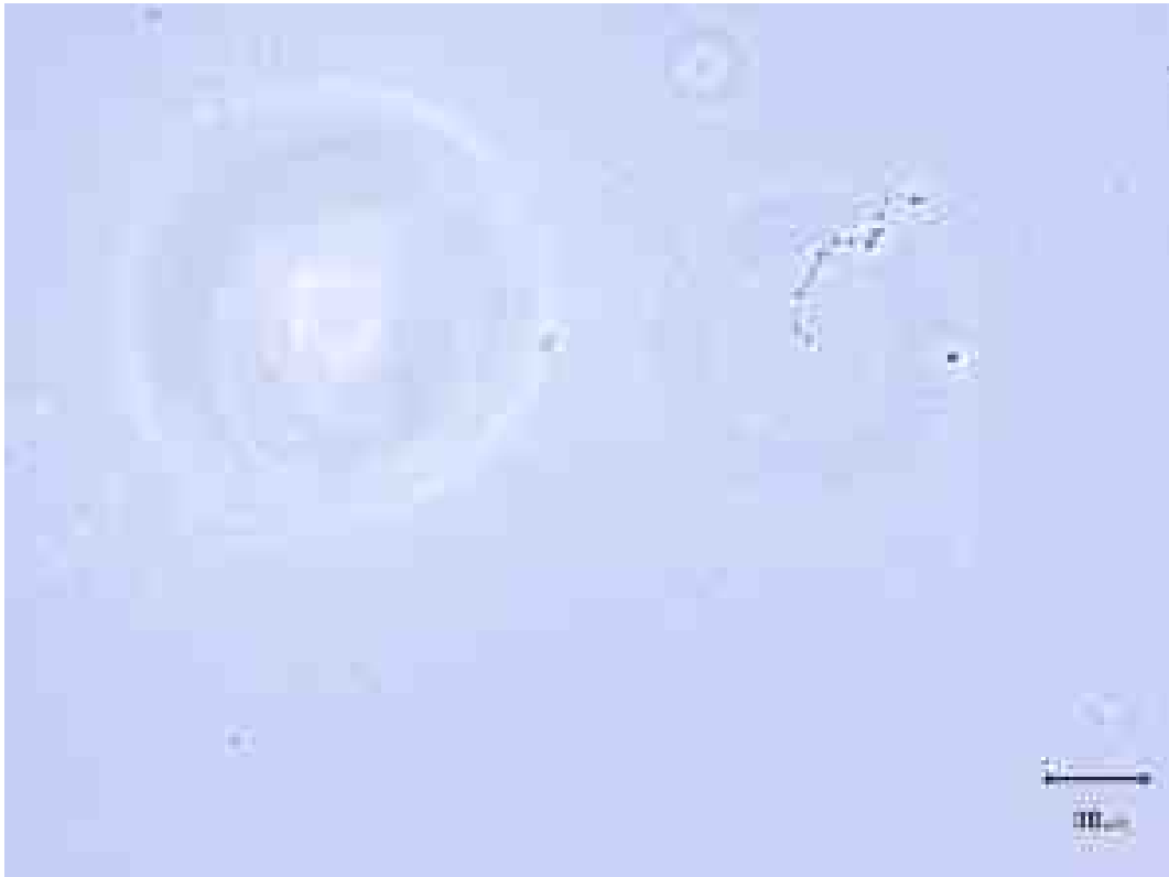
写真 1. 試料 No.5 で検出されたクリソタイル。(位相差像)
