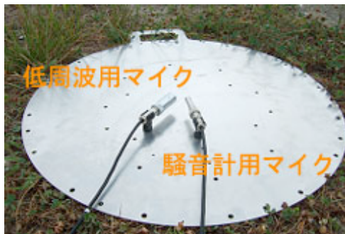
反射板にマイクロホンをセットした様子
