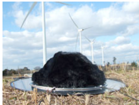
風力発電装置音測定時にウインドジャマーを使用している例
