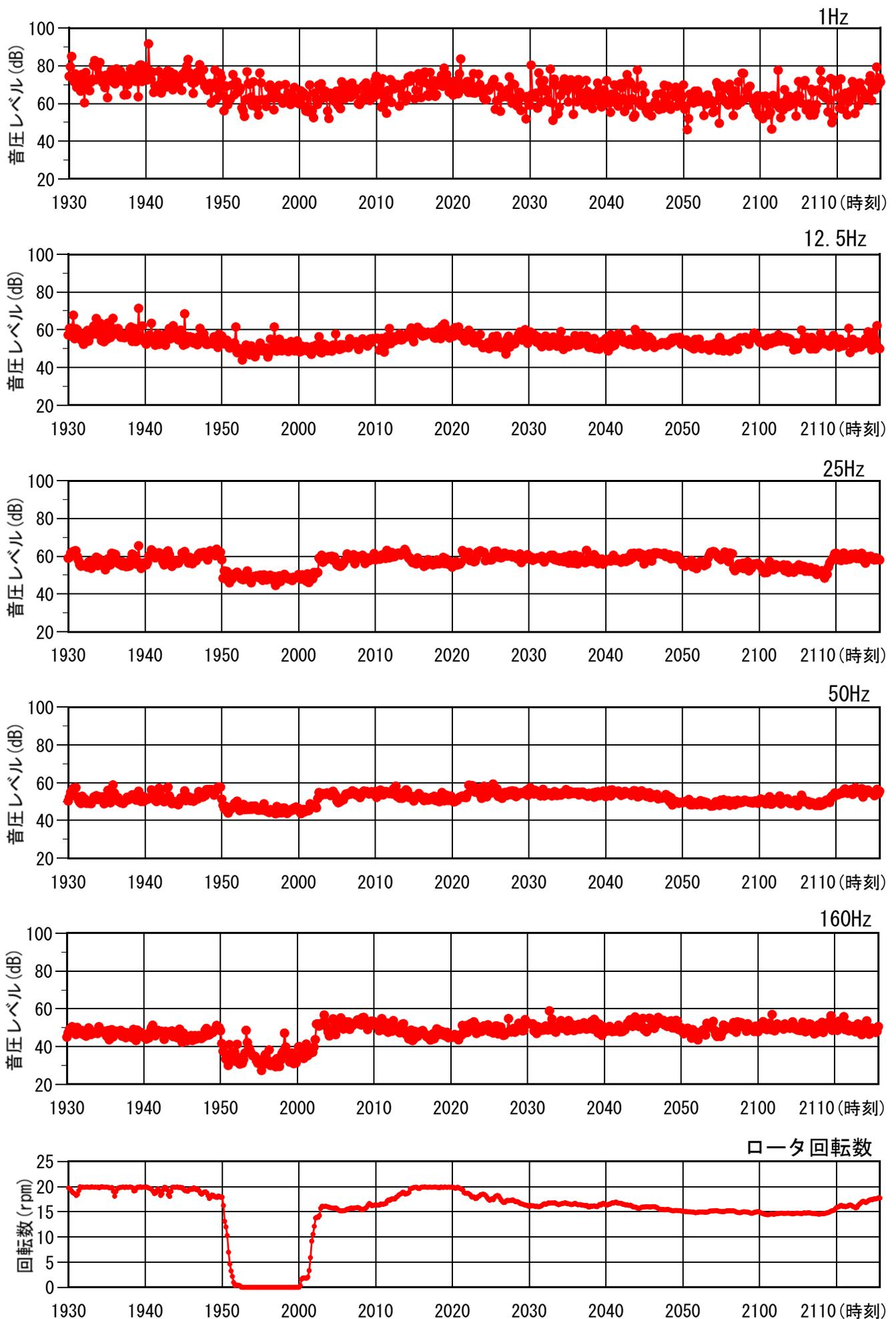
図2. 2. 1. 51 風車音の周波数別音圧レベル時間変動とロータ回転数の時間変化
