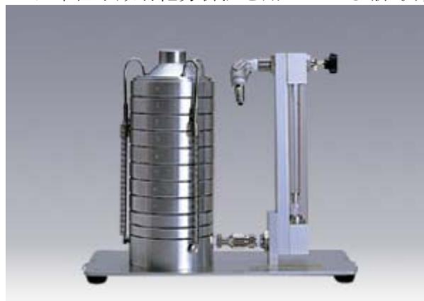
図 2.1-2 ロウボリウムアンダーセンエアサンプラ外観
