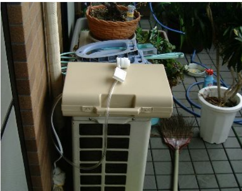
図 2.1-2 家屋内外測定用の個人サンプラの設置例
