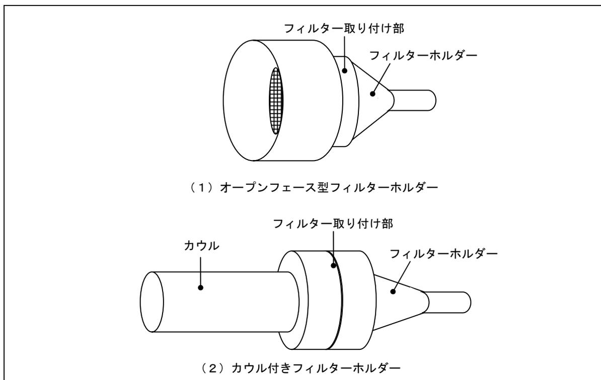
図 2 フィルターホルダーの図又は写真
