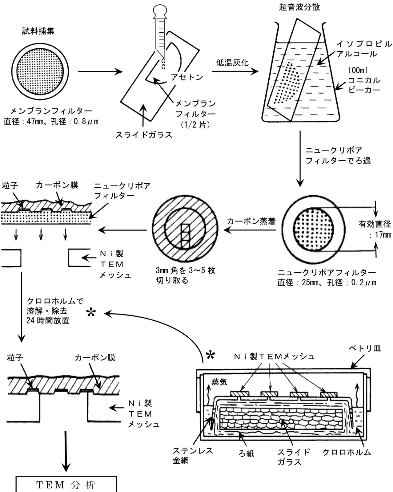
図12 電子顕微鏡観察試料の調整方法
