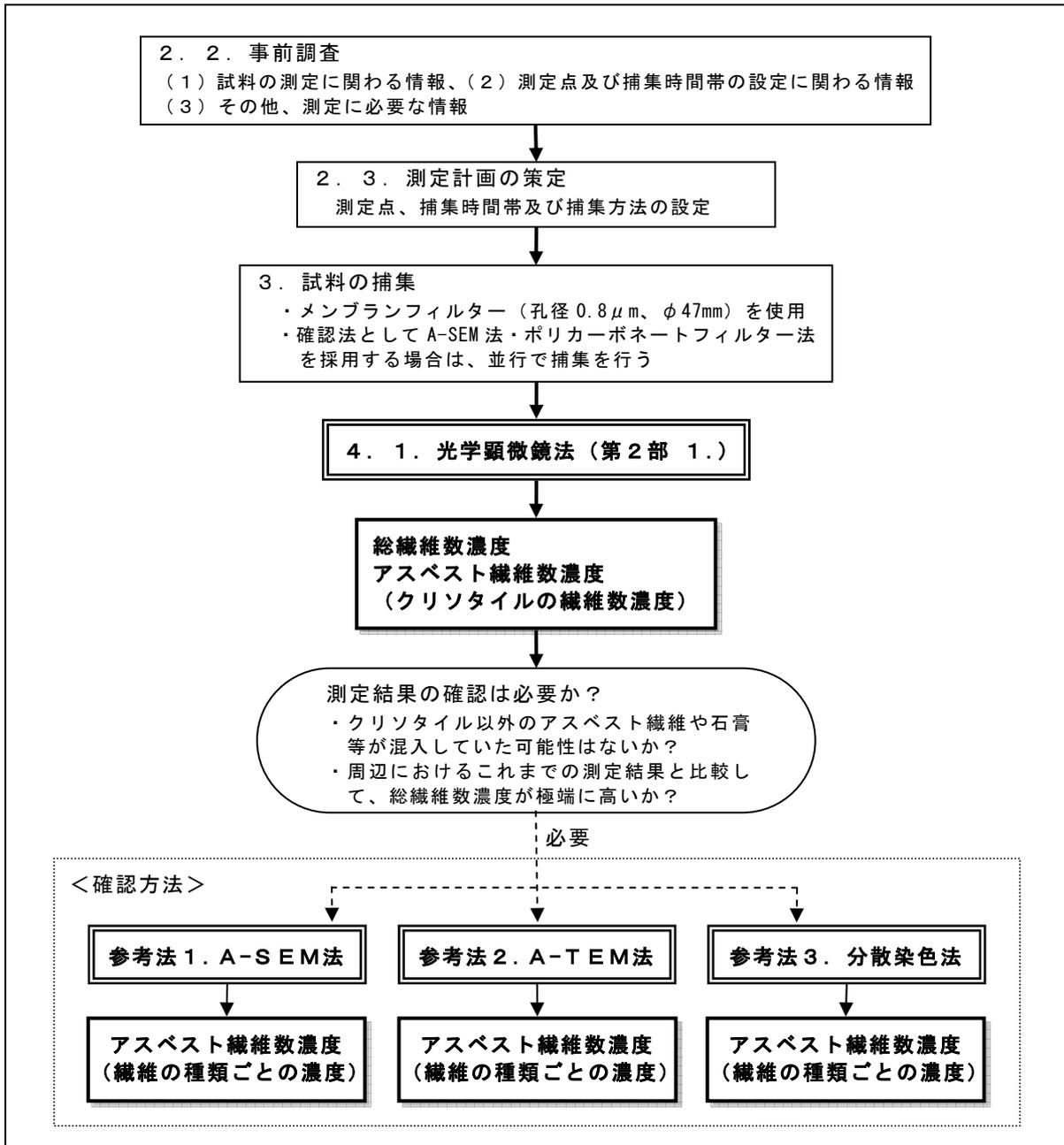
図IV-1 「アスベストモニタリングマニュアル（改訂原案）」における測定フロー
