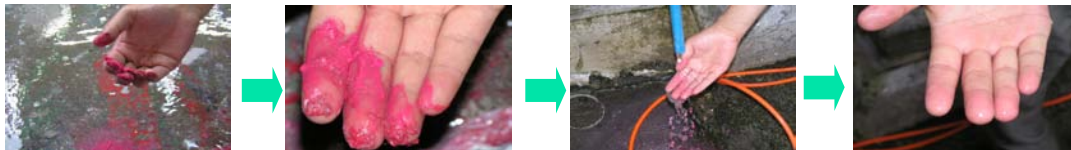
写真4: 塗料スラッジの性状変化 (水で簡単に落ちる)
