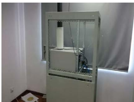
既存XRFとの比較試験のための堀場製作所PX-375設置状況
