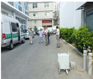
アモイ市での自動車排ガス測定実験
