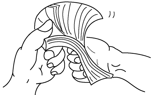
記録紙が重なって送られることを防止するため、記録紙の一端を持って左右に振り、よくほぐす。他端も同じようにほぐす。
