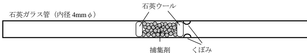
図2 水銀捕集管の例
