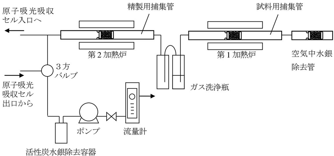
図3 水銀分析用加熱気化装置の例
