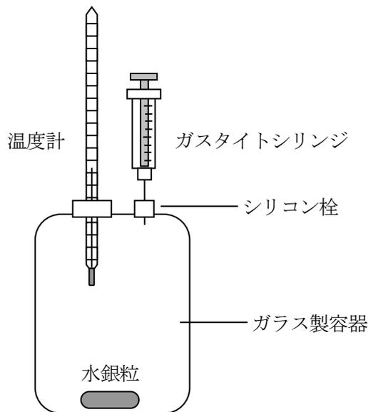
図4 水銀蒸気飽和ガス調整装置の概要
