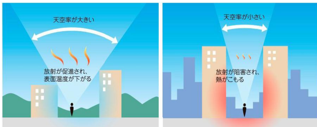
図 1.26 天空率と放射の関係 資料) 環境省：ヒートアイランド対策ガイドライン
