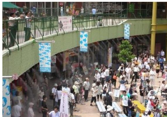
商業施設の軒下に、微細ミストを設置した例。駅からの出口や店舗が立ち並ぶ通路沿いに設置されている。温湿度センサーで気象条件に応じた運転をしている。
