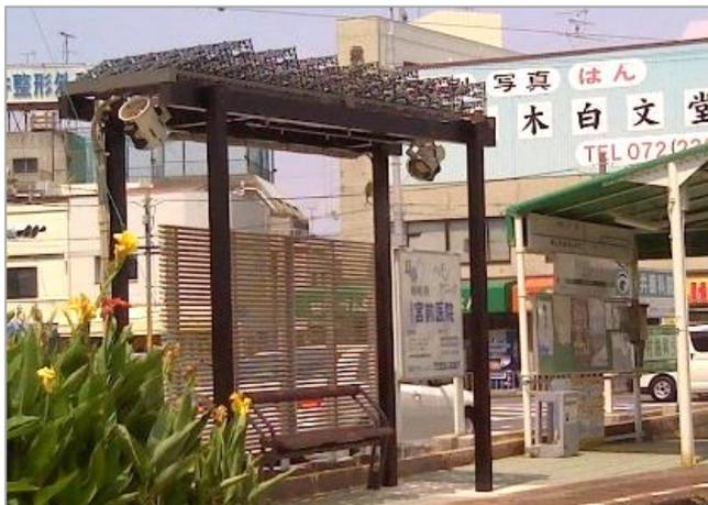
高温化した車道と軌道に囲まれた路面電車の電停に暑さ対策を実施した例。施工可能な面積が 6 m<sup>2</sup>程度と限られていたため、ベンチに座る人を直接冷やす送風ファン付き微細ミストを導入した。
