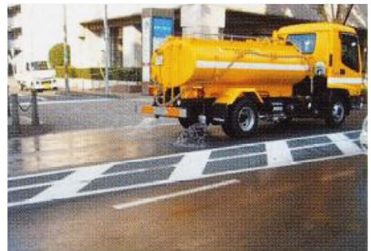
図 3.43 散水車による散水
