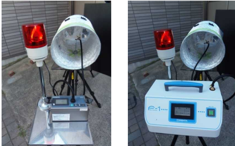
図 3. 126 排気ダクト内の測定時に警告灯を設置した例
