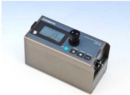
図 3. 129 吸引ポンプ内蔵の粉じん相対濃度計の例
