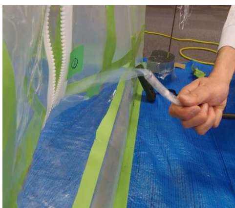
図 3.121 スモークテスターによる確認
