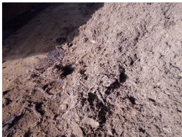
写真6 生物脱臭槽に積んでいるバーク
