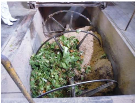
写真 1 回転式の混合機で原料を混合
