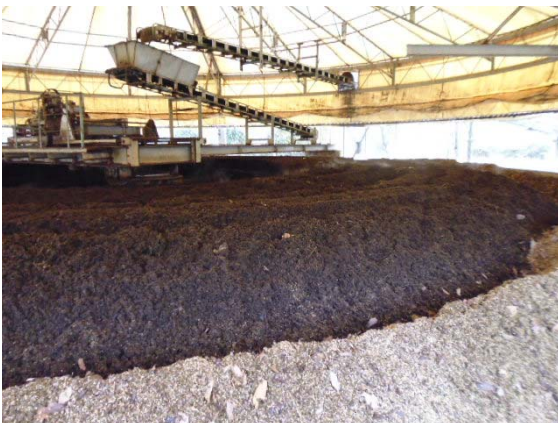
写真3 一次発酵棟（円の外側から内側へ移動）
