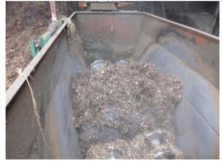
写真3 木質チップに液状化食品残さを混合
