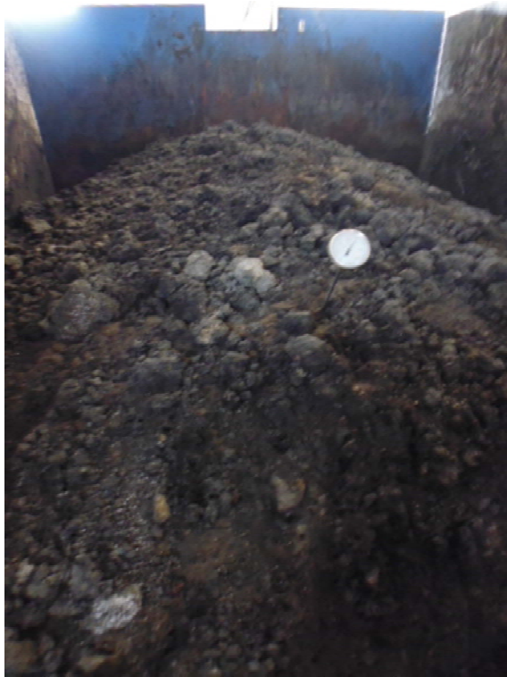
写真5 発酵槽には各1本温度計が装備されていた
