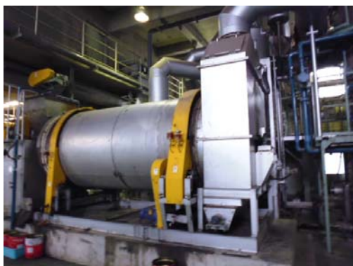
写真 1 汚泥乾燥炉 (800°Cで熱風乾燥)
