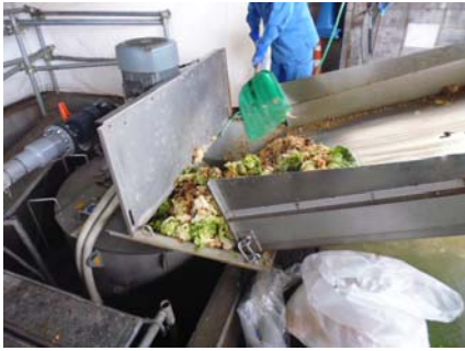
写真1 食品残さをミキサーにかける
