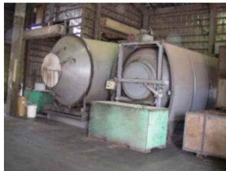
写真 2 密閉横型発酵装置 (左: 30m 3 、右: 15m 3 )
