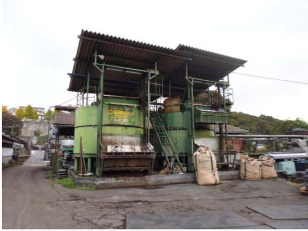
写真7 密閉縦型発酵装置 (S社2基)
