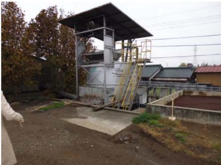
写真8 密閉縦型発酵装置
