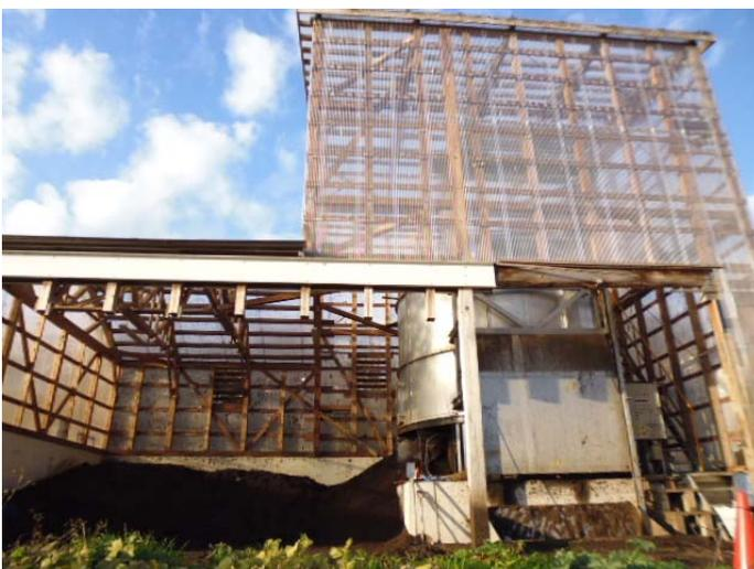
写真3 密閉縦型発酵装置
