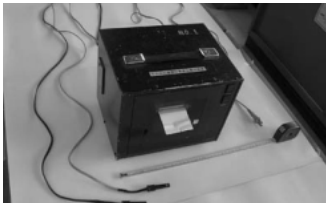
写真 1 排水ポンプの稼働を記録する稼働状況記録計
