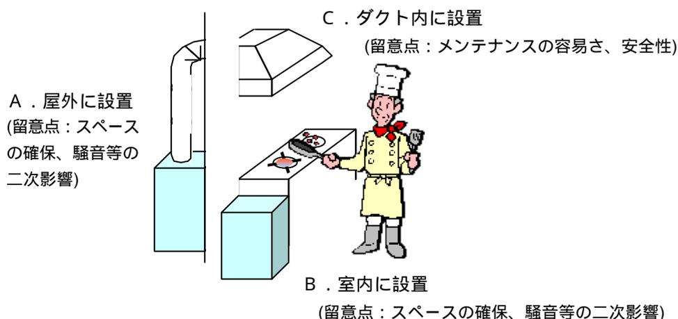
脱臭装置の設置場所には、大きく分けて屋外、室内、ダクト（捕集した臭気を含む排出ガスを通す管）内があります。屋外や屋内に設置する場合には、スペースの確保が必要です。また、騒音などが気になる場合もあります。設置スペースがない場合には、屋上や屋根に設置することも可能ですが、設備工事費などに影響しますので、メーカーとよく相談しましょう。また、臭気の排出口は近隣に影響しないように、できるだけ高い位置に設け、排出する向きを考えることが大切です。
