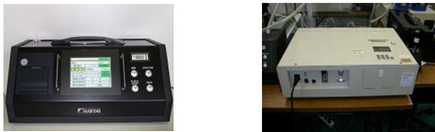
図4.14.4 繊維状粒子自動計測器の例（2）
