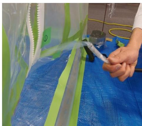
図 4.14.10 スモークテスターによる確認
