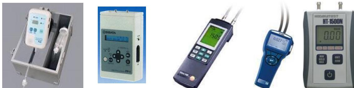
図4.14.5 マイクロマノメーター（精密微差圧計）例
