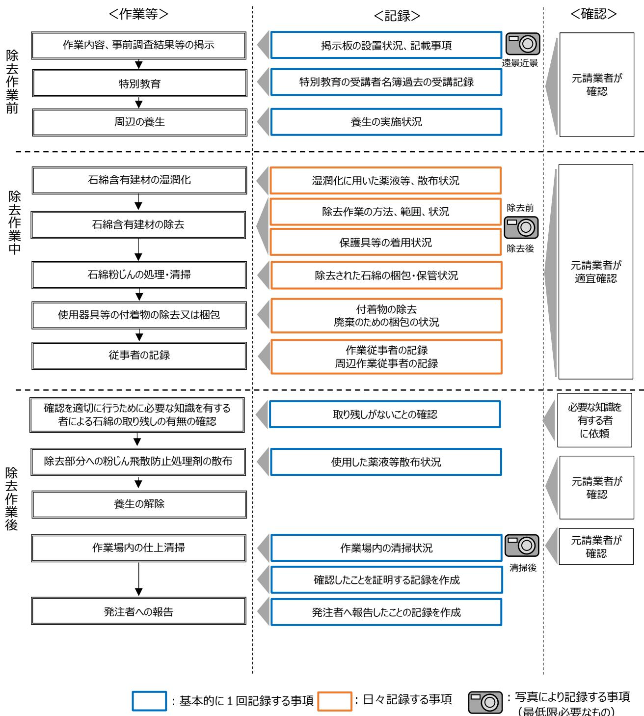
図4.15.3 石綿含有保温材等の切断等を行わない作業における記録・確認の例
