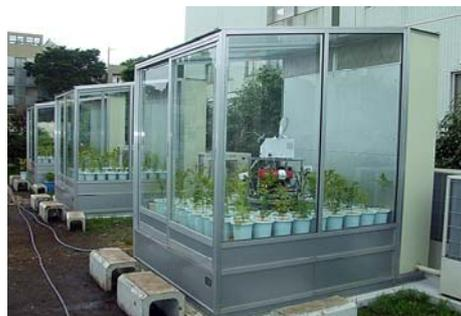
写真1 粒子暴露チャンバー
