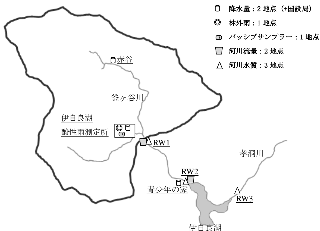
図 2-3. 伊自良湖集水域モニタリング装置配置図
