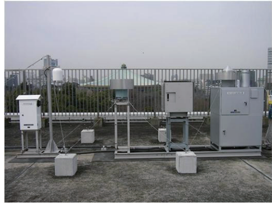
試料捕集装置と雨量計(国設東京酸性雨測定所)
