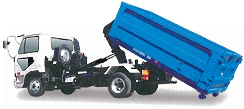
図 3-8 脱着装置付コンテナ専用車の例
