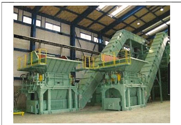
図 4-3 破砕機の屋内設置の例
